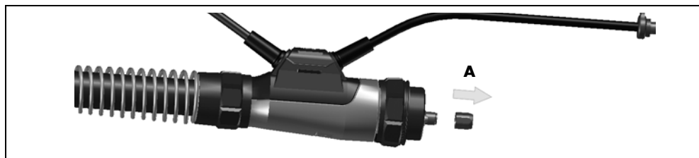
Сл. 5 Уклањање насадне матице
